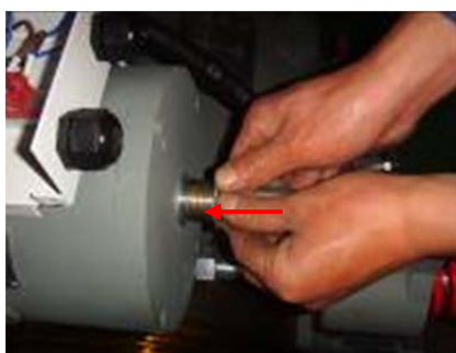
图 3 柱塞的灵活度检查
