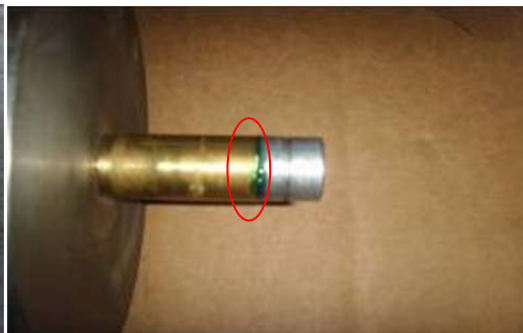
图 10 胶水溢出示意图
