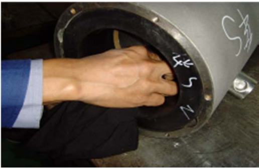
图 6 清理制动器内部
